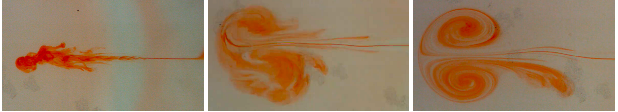
FIGURE 3 – Formation du vortex dipolaire grâce au dispositif expérimental.
